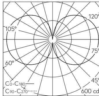
LED 3000 K 50.5 W 5023 lm-h / CIE Flux 17 42 69 51 100 / C11 nach DIN 5040
