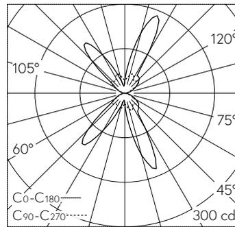
LED 3000 K 14 W 364 lm-h / CIE Flux 56 87 97 49 100 / C54 nach DIN 5040
