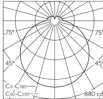
LED 3000 K 27.7 W 3144 lm-h / CIE Flux 40 70 89 83 100 / B31 nach DIN 5040
