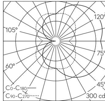
LED 3000 K 20 W 1609 lm-h / CIE Flux 29 57 80 50 100 / C22 nach DIN 5040
