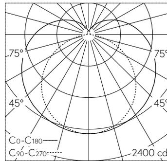
LED 3000 K 80 W 9425 lm-h / CIE Flux 36 64 84 79 100 / B31 nach DIN 5040
