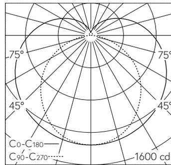
LED 3000 K 61 W 6905 lm-h / CIE Flux 35 63 84 79 100 / B31 nach DIN 5040
