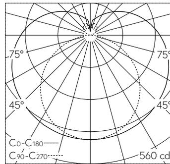
LED 3000 K 26.6 W 2650 lm-h / CIE Flux 34 62 83 72 100 / B21 nach DIN 5040
