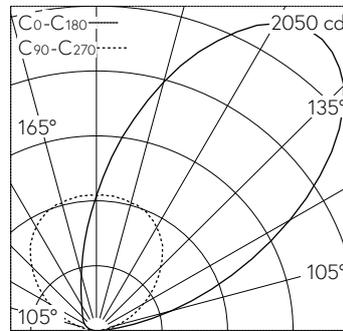
LED 4000 K 36.1 W 3501 lm-h / CIE Flux 0 0 0 100 / E83 nach DIN 5040
