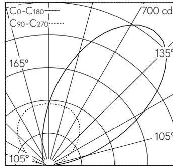
LED 4000 K 12.5 W 1121 lm-h / CIE Flux 0 0 0 100 / E83 nach DIN 5040
