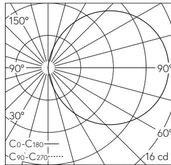
LED 3000 K 2.1 W 42 lm-h / CIE Flux 13 37 66 50 100 / C11 nach DIN 5040
