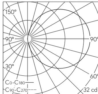
LED 2700 K 3 W 76 lm-h / CIE Flux 13 37 66 50 100 / C11 nach DIN 5040
