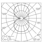
LED 3000 K 9 W 541 lm-h / CIE Flux 38 68 88 50 100 / C33 nach DIN 5040
