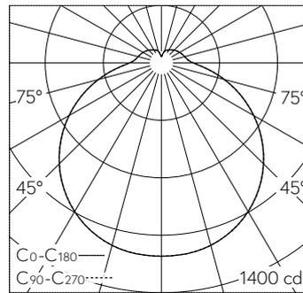
LED 2700 K 48.8 W 4906 lm-h / CIE Flux 40 70 89 84 100 / B31 nach DIN 5040
