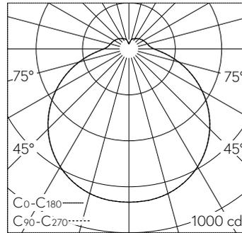
LED 2700 K 31 W 3473 lm-h / CIE Flux 40 70 89 84 100 / B31 nach DIN 5040
