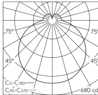
LED 2700 K 29.4 W 2510 lm-h / CIE Flux 40 70 89 81 100 / B32 nach DIN 5040
