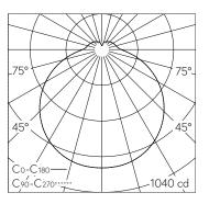
LED 3000 K 31 W 3590 lm-h / CIE Flux 40 70 89 84 100 / B31 nach DIN 5040
