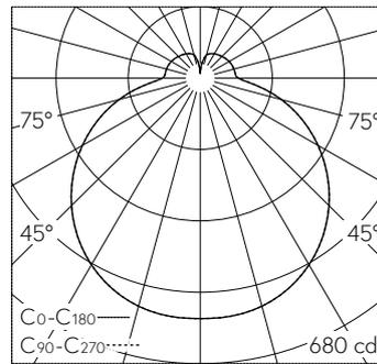
LED 2700 K 31.1 W 2510 lm-h / CIE Flux 40 70 89 81 100 / B32 nach DIN 5040
