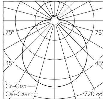
LED 2700 K 31 W 2295 lm-h / CIE Flux 42 71 89 87 100 / B31 nach DIN 5040
