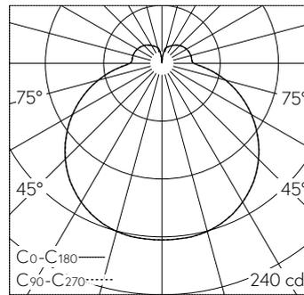
LED 3000 K 10 W 808 lm-h 132°/132° / CIE Flux 38 67 87 79 100 / B31 nach DIN 5040
