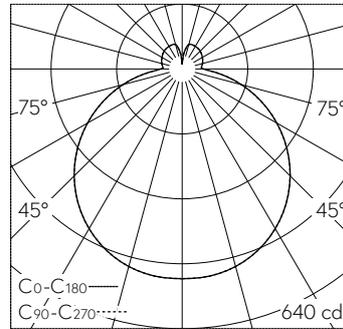
LED 3000 K 19.1 W 2062 lm-h / CIE Flux 42 73 91 83 100 / B32 nach DIN 5040
