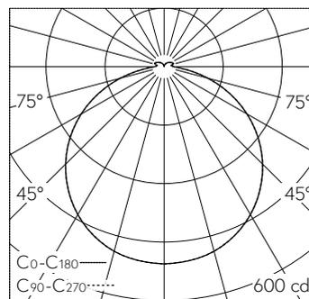
LED 4000 K 22.2 W 1660 lm-h 116° / CIE Flux 45 76 94 93 100 / A41 nach DIN 5040
