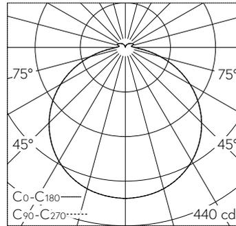
LED 3000 K 15.6 W 1129 lm-h 118° / CIE Flux 44 76 93 93 100 / A41 nach DIN 5040
