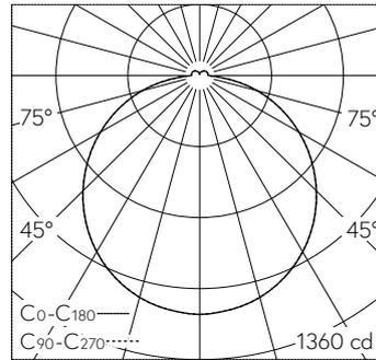
LED 4000 K 47.4 W 3452 lm-h 116° / CIE Flux 45 75 93 94 100 / A41 nach DIN 5040
