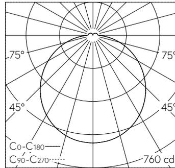
LED 4000 K 22.2 W 2031 lm-h 116° / CIE Flux 44 75 92 94 100 / A41 nach DIN 5040
