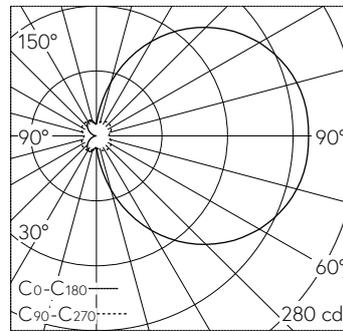
LED 3000 K 11 W 1160 lm-h / CIE Flux 17 42 70 50 100 / C11 nach DIN 5040
