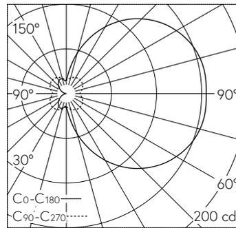
LED 4000 K 6.7 W 666 lm-h / CIE Flux 18 44 71 50 100 / C12 nach DIN 5040
