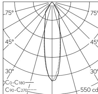
LED 3000 K 2.9 W 157 lm-h / CIE Flux 98 100 100 100 100 / A80 nach DIN 5040
