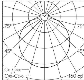
LED 4000 K 5.8 W 453 lm-h 120° / CIE Flux 44 74 92 90 100 / A31 nach DIN 5040
