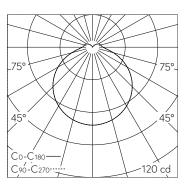
LED 4000 K 3.9 W 279 lm-h 122° / CIE Flux 42 73 91 88 100 / B31 nach DIN 5040
