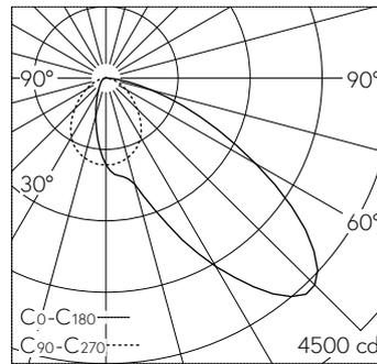
LED 3000 K 35.6 W 4651 lm-h / CIE Flux 39 78 96 100 100 / A30 nach DIN 5040
