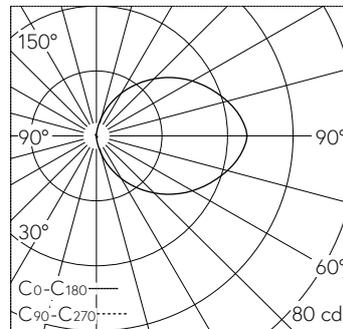
LED RGB 0 K 10.2 W 116 lm-h / CIE Flux 11 34 63 50 100 / C11 nach DIN 5040
