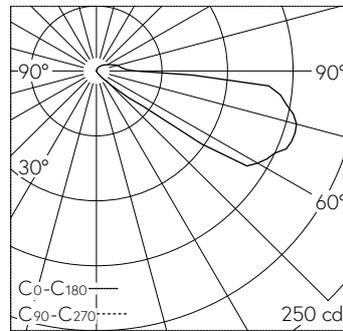
LED 3000 K 3.6 W 173 lm-h / CIE Flux 1 13 56 88 100 / B11 nach DIN 5040
