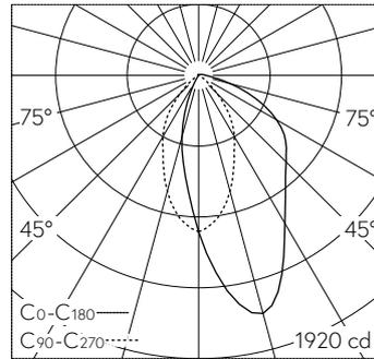
LED 3000 K 23 W 1785 lm-h / CIE Flux 62 86 97 99 100 / A50 nach DIN 5040
