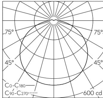
LED 3000 K 17 W 1670 lm-h 122°/122° / CIE Flux 42 73 92 96 100 / A31 nach DIN 50...
