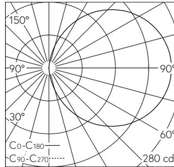
LED 3000 K 8.8 W 830 lm-h / CIE Flux 13 37 66 50 100 / C11 nach DIN 5040
