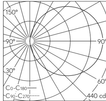
LED 4000 K 14 W 1160 lm-h / CIE Flux 13 37 66 50 100 / C11 nach DIN 5040
