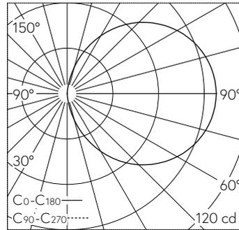
LED 3000 K 4.8 W 355 lm-h / CIE Flux 13 37 66 50 100 / C11 nach DIN 5040
