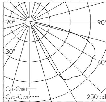
LED 3000 K 5.1 W 277 lm-h / CIE Flux 17 55 89 98 100 / A10 nach DIN 5040
