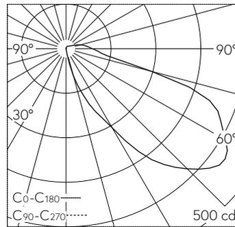
LED 3000 K 9 W 703 lm-h / CIE Flux 17 55 87 91 100 / A11 nach DIN 5040
