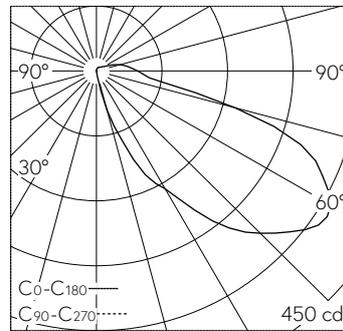
LED 4000 K 7.2 W 558 lm-h / CIE Flux 16 52 86 90 100 / A11 nach DIN 5040
