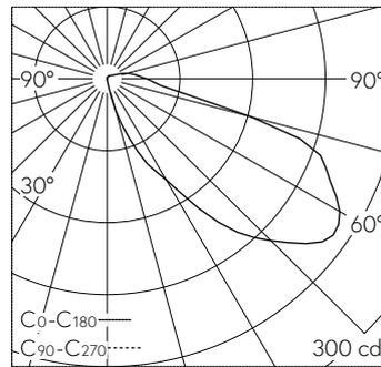
LED 3000 K 4.9 W 389 lm-h / CIE Flux 16 54 87 92 100 / A11 nach DIN 5040
