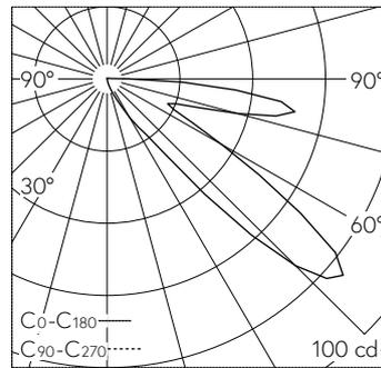
LED 3000 K 4.8 W 53 lm-h / CIE Flux 8 51 74 98 100 / A10 nach DIN 5040
