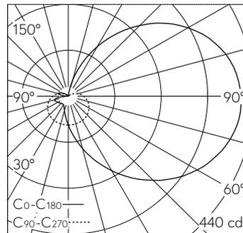
LED 3000 K 16.3 W 1309 lm-h / CIE Flux 19 43 70 57 100 / C11 nach DIN 5040
