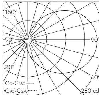
LED 3000 K 9 W 815 lm-h / CIE Flux 19 44 70 58 100 / C11 nach DIN 5040
