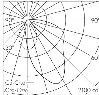
LED 4000 K 18.8 W 2413 lm-h / CIE Flux 43 71 91 99 100 / A30 nach DIN 5040
