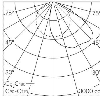
LED 4000 K 26.5 W 3032 lm-h / CIE Flux 47 83 97 100 100 / A40 nach DIN 5040
