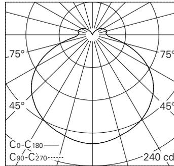
LED 3000 K 10.2 W 881 lm-h / CIE Flux 39 70 90 85 100 / B31 nach DIN 5040
