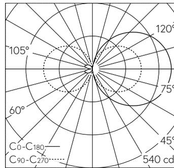
LED 3000 K 22.6 W 2381 lm-h / CIE Flux 13 37 66 50 100 / C11 nach DIN 5040
