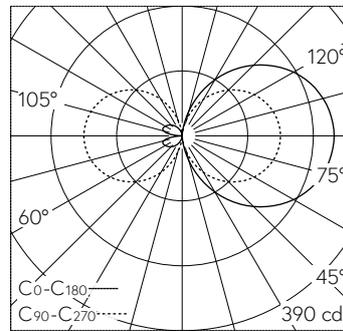
LED 4000 K 18.6 W 1739 lm-h / CIE Flux 13 37 66 50 100 / C11 nach DIN 5040
