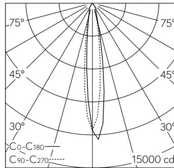
LED 3000 K 19 W 1607 lm-h / CIE Flux 99 100 100 100 100 / A80 nach DIN 5040
